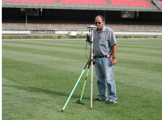
Foto: 1.1 – GPS instalado no centro do gramado do Mineirão
