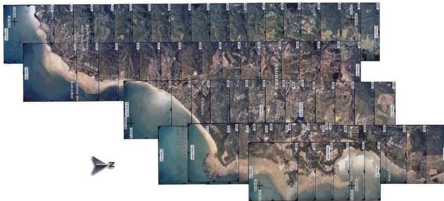
Figura 1.10 - Blocos de aerofotos aerotriangulados
