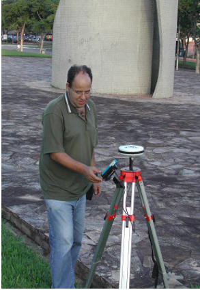
Foto 3.4 – Programação do receptor instalado na Reitoria do campus
