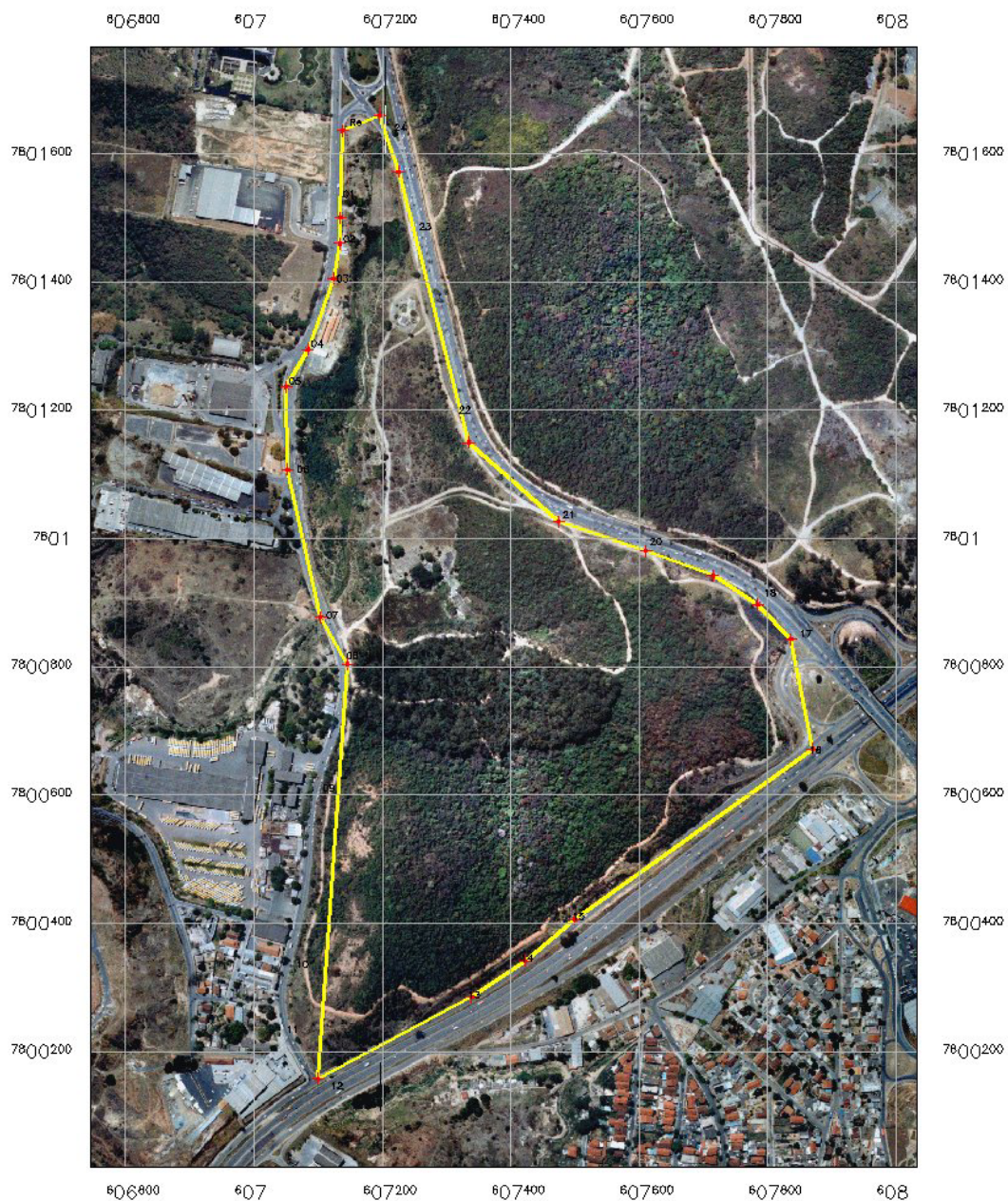
Figura 13 – Poligonal determinada pela Estação Total, sem os vértices 9, 10 e 11, sobre imagem aérea da área de estudo.
