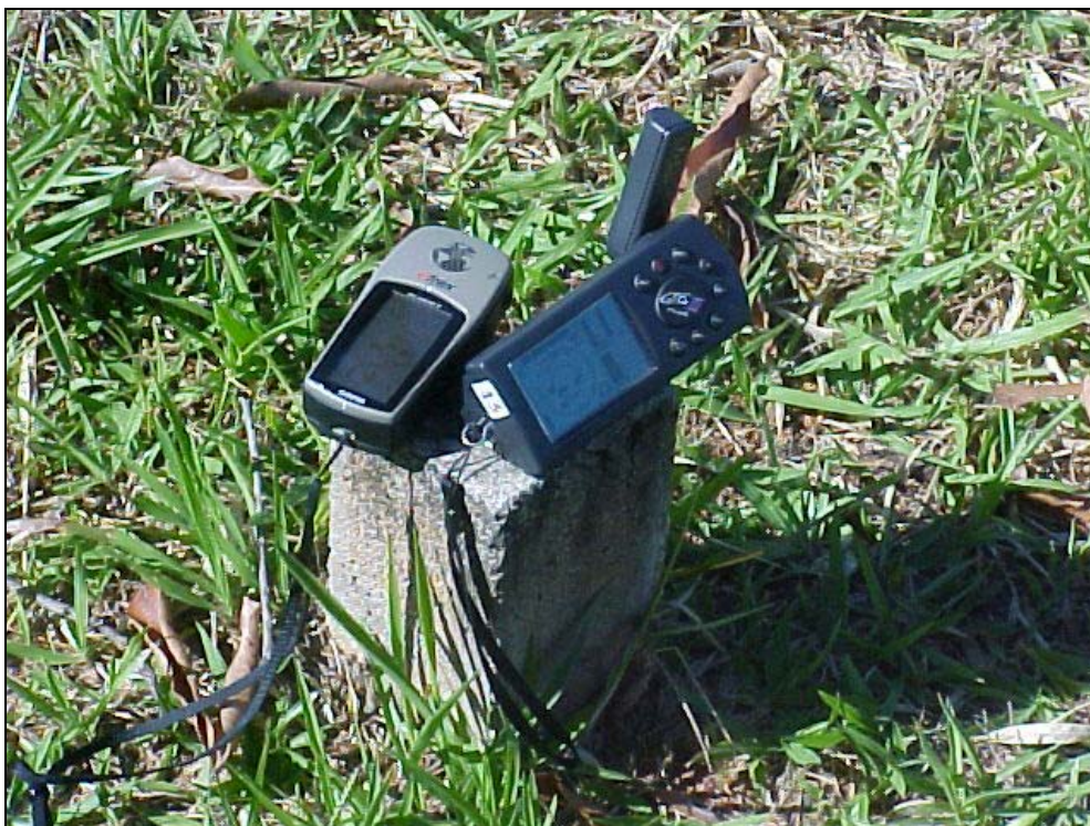
Figura 14 – Receptores GPS eTrex Summit e GPS III estacionados sobre marco ICG II.
