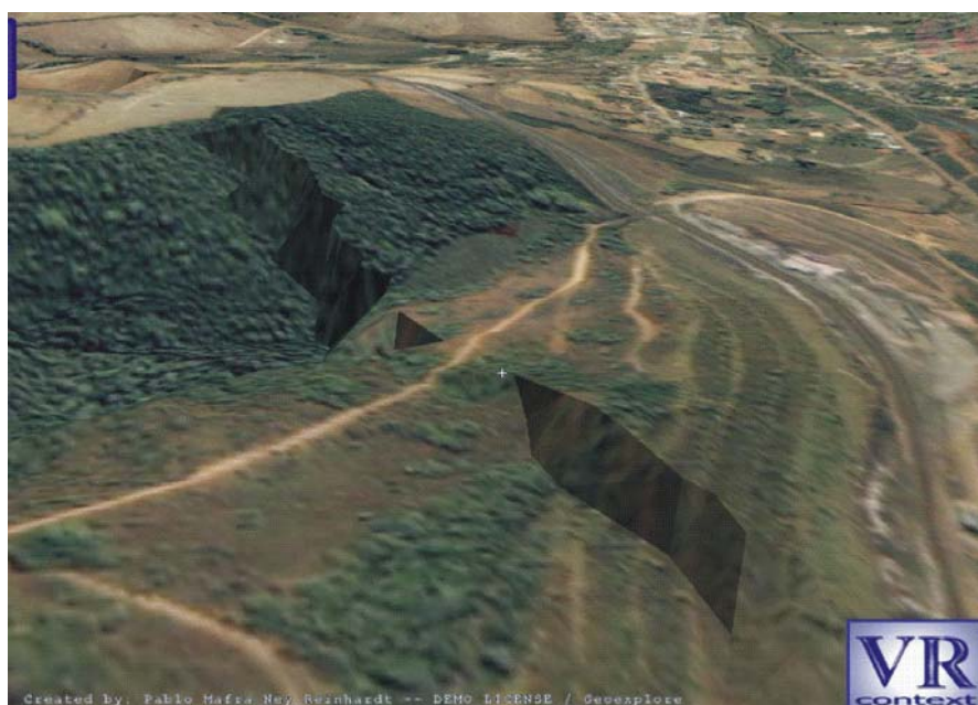
Figura 58: Resultado da interpolação de dados topográficos de diferentes densidades no Walkinside .
