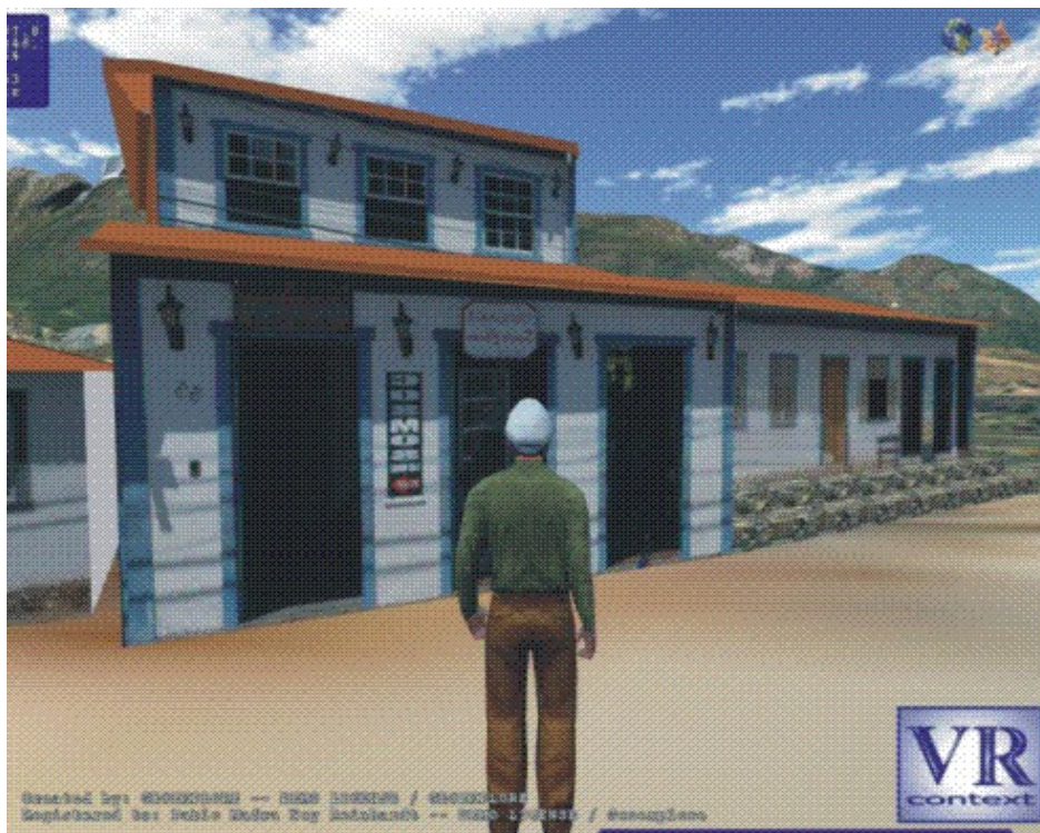
Figura 29: Modelo 3D com texturas aplicadas. Fotos das fachadas das edificações e imagem IKONOS aplicada sobre MDT.
