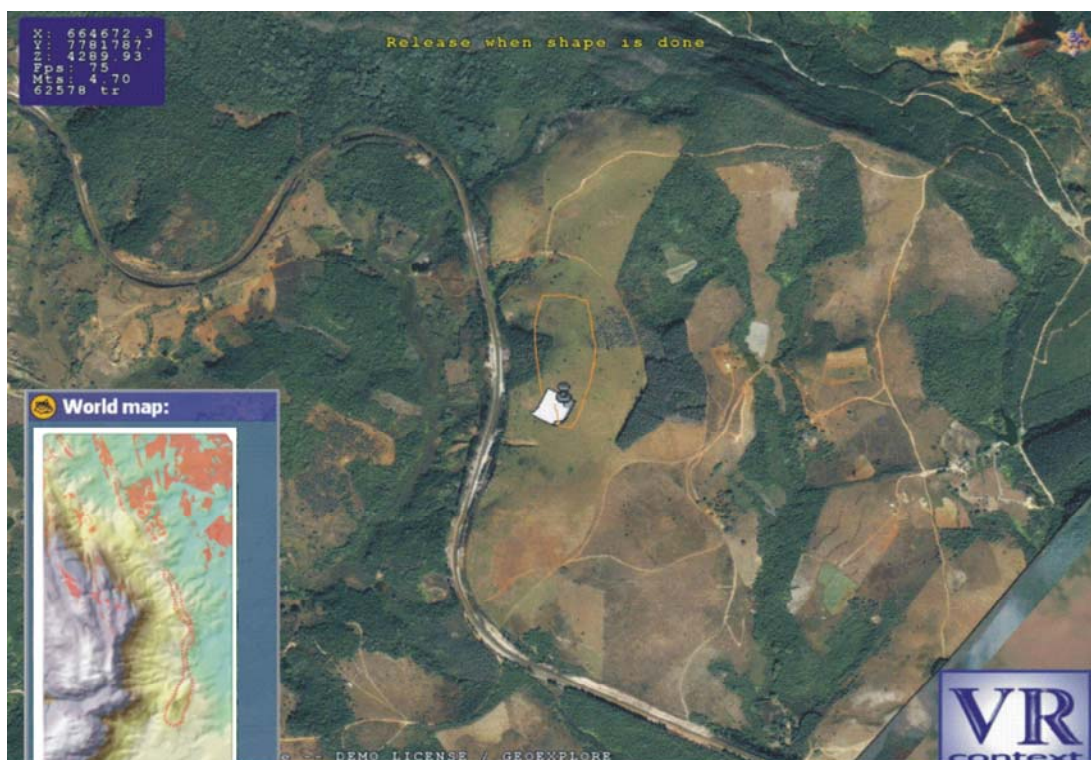
Figura 25: Escolha do melhor local para se implantar uma mina no Walkinside com o auxílio de visualização 2D de resultado da análise espacial que teve como critérios declividades abaixo de 15 graus e não visibilidade em relação às minas da região
