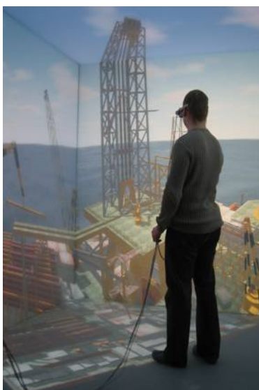
Figura 4: Moderno sistema de realidade virtual por projeção para revisão de projetos industriais.
