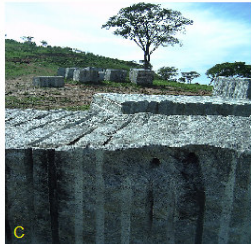
Figura 2.9: Afloramento de gnaiss migmatítico, FC05; A) Pormenor da rocha B) Pedreira paralisada, na fazenda Mandaçaia, município de Oliveira C) Blocos abandonados, não comercializados por causa de defeitos ou impurezas
