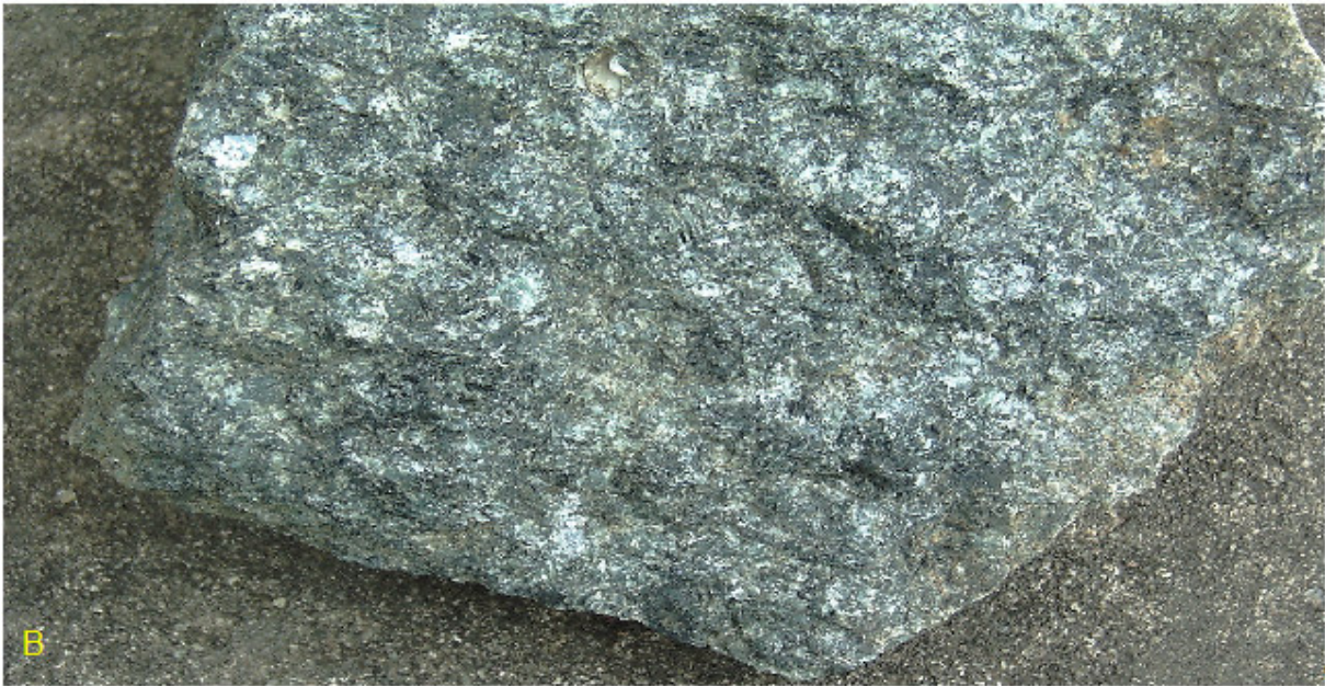
Figura 2.11: A) Afloramento de granito Kfeldspato, verde, no município de São Francisco de Paola, FC07 B) Pormenor da rocha, evidencia a textura homogênea do granito kfelspatico
