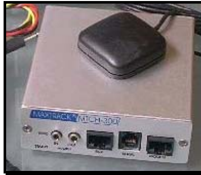
Fig. 10 – Módulo de transmissão via GPRS
