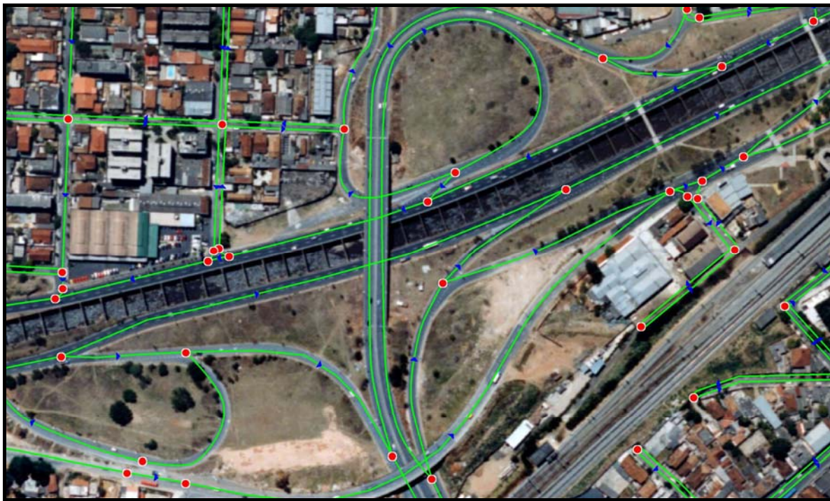
Fig. 13 – Foto Área com base cartográfica digital sobreposta. Onde as linhas verdes com a seta azul ao centro representam a direção do fluxo de veículos da via (mão de direção) e os pontos vermelhos indicam a ligação entre as extremidades das linhas.
